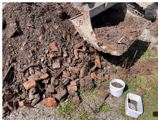
Figur 2.4: Bilder som viser prøvegroppen gravd ved prøvepunktet PG5.313, samt oppgravde masser. Foto: Multiconsult.
