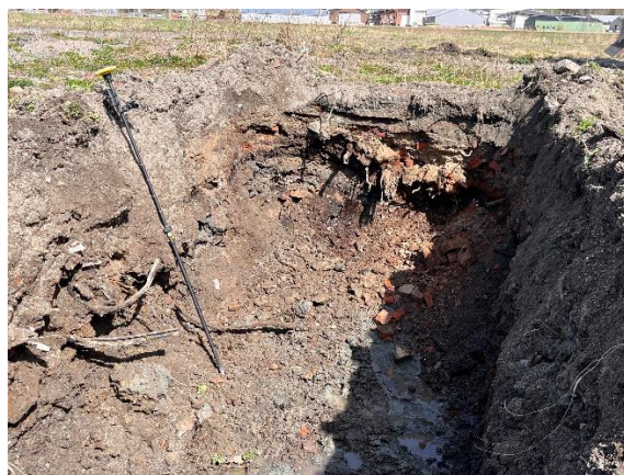
Figur 2.2: Bilder som viser prøvegroppen gravd ved prøvepunktet PG5.22, samt oppgravde masser. Foto: Multiconsult.
